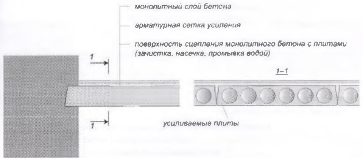
Рисунок 4. Набетонка – наращивание перекрытия с обеспечением качественного сцепления
